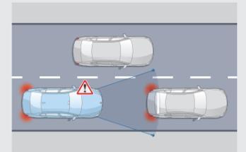
**Détection de collision avant avec freinage**
