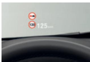
**Speed Limit Info** vous évite d'être pris en défaut dans votre conduite. Pour plus d'efficacité, l'affichage des limitations de vitesse et des interdictions de dépassement se fait à la fois sur le tableau de bord et dans l'affichage Tête Haute HUD en couleur (équipement en option).
