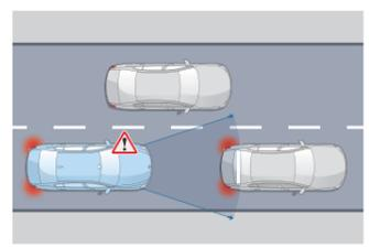
**Détection de collision avant avec freinage**
