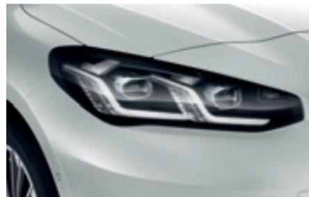
**Le projecteur Advanced Full LED** avec gestion automatique des feux de route. La fonctionnalité anti-éblouissement "BMW Selective Beam" avec projecteurs directionnels répartis de façon variable le faisceau lumineux pour un éclairage optimal de la route et une meilleure visibilité dans l'obscurité.
