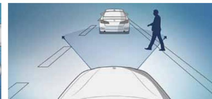
La **Protection active des piétons et Système anti-collision** à basse vitesse assiste le conducteur activement en évitant les collisions avec les piétons. Jusqu'à une vitesse de 60 km/h, il avertit le conducteur tout en préconditionnant les freins pour une réactivité maximale. En cas d'urgence, le système empêche une collision ou assure une nette diminution de la vitesse de collision.
