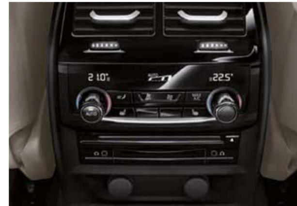
Inclut des fonctionnalités étendues en plus des fonctionnalités de la climatisation automatique 2 zones ainsi que deux aérateurs sur les montants centraux. Par ailleurs, les passagers arrière bénéficient d'un réglage individuel via une commande séparée avec affichage.
