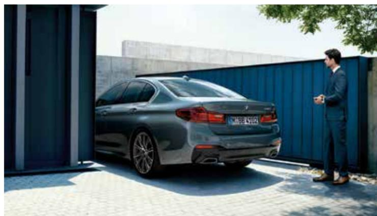
Pour les emplacements de parking étroits où la sortie/l'accès au véhicules est difficile pour le conducteur et les passagers, le véhicule peut de manière automatique être garé (en marche avant) et sortie d'un emplacement en bataille en activant la fonction «Remote Control Parking» sur la BMW Display Key. Le conducteur étant à l'extérieur du véhicule pendant la manœuvre. (Indisponible sur BMW 520d Efficient Dynamics Edition et BMW 530e iPerformance)
