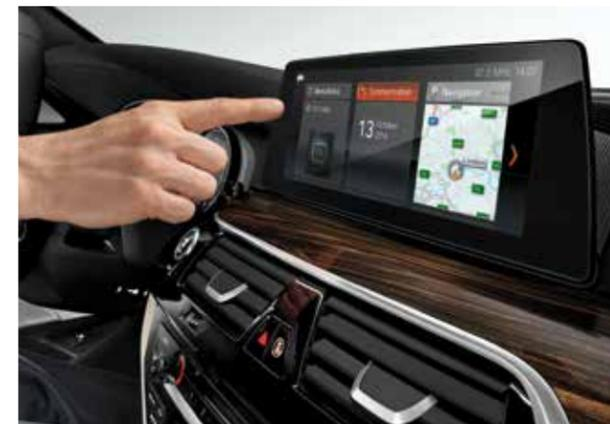
Grâce à la commande gestuelle BMW, il est possible de piloter certaines fonctions grâce à des mouvements précis de la main. Pour certaines commandes, le système reconnaît ainsi les gestes « balayer » ou « montrer », qui permettent notamment d'accepter ou de rejeter un appel entrant, ou encore de régler le volume sonore. Pour régler le volume sonore, il suffit d'effectuer un mouvement rotatif avec l'index.
