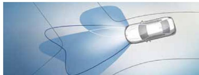
Les **projecteurs directionnels à LED avec répartition variable** de la lumière en ville et sur autoroute et feux de route permanents anti-éblouissement «BMW Selective Beam» assurent un éclairage optimal de la chaussée. L'éclairage d'intersection compris dans l'équipement s'active automatiquement, même à l'arrêt, dès que le clignotant est actionné ou à partir d'un certain angle de rotation du volant et ce jusqu'à une vitesse de 35 km/h.
