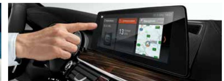
Grâce à la **commande gestuelle BMW**, il est possible de piloter certaines fonctions grâce à des mouvements précis de la main. Pour certaines commandes, le système reconnaît ainsi les gestes «balayer» ou «montrer», qui permettent notamment d'accepter ou de rejeter un appel entrant, ou encore de régler le volume sonore. Pour régler le volume sonore, il suffit d'effectuer un mouvement rotatif avec l'index.
