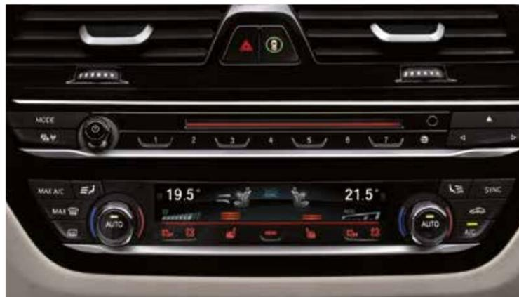
Le chauffage des sièges chauffe la surface d'assise et le dossier des sièges avant et arrière latéraux, la température étant réglable sur trois niveaux et séparément pour chaque siège. Avant même que le moteur n'atteigne sa température de service, il suffit d'une pression sur un bouton pour que les sièges chauffants diffusent rapidement, et ce quelle que soit la température extérieure, une chaleur agréable.
