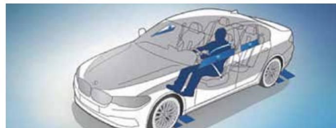
La **Protection active** des occupants est un système de sécurité préventif signé BMW ConnectedDrive. Elle prévient le conducteur en cas de fatigue ; dans les situations critiques, les ceintures de sécurité sont prétendues, le dossier des sièges à réglages électriques est redressé, les vitres et le toit ouvrant sont fermés. Après un accident, le système freine automatiquement la voiture jusqu'à l'arrêt.
