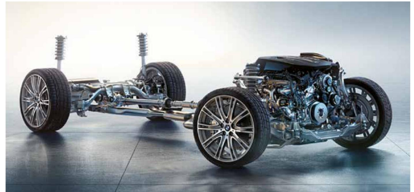
La **direction ActiveDrive<sup>1</sup>** à 4 roues directrices associe une démultiplication asservie à l'angle de braquage sur l'essieu avant à des roues arrière directrices. À faible vitesse, ces dernières braquent dans le sens inverse des roues avant afin de garantir un surcroît de maniabilité et d'agilité. À partir d'environ 60 km/h, les roues arrière braquent dans le même sens que les roues avant pour augmenter la stabilité et le confort.
