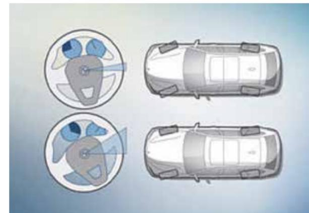
La direction ActiveDrive à 4 roues directrices associe une démultiplication asservie à l'angle de braquage sur l'essieu avant à des roues arrière directrices. À faible vitesse, ces dernières braquent dans le sens inverse des roues avant afin de garantir un surcroît de maniabilité et d'agilité. À partir d'environ 60 km/h, les roues arrière braquent dans le même sens que les roues avant pour augmenter la stabilité et le confort.
