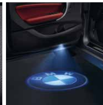
Logo BMW projeté sur le sol sous l'une des portes et permettant notamment d'éclairer la zone d'entrée du véhicule.
