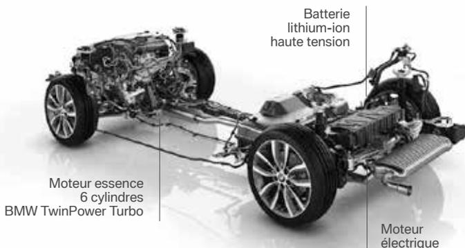
Pour une gestion intelligente de l'énergie, le système hybride coordonne l'interaction des composants moteur et de la transmission BMW.
