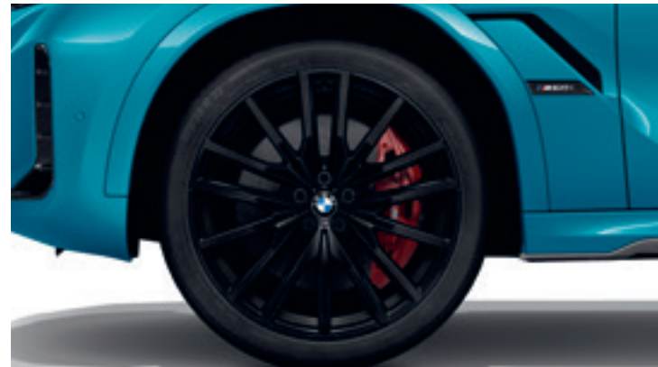
Alliage léger 22" style 742 M Black Pneus mixtes 9,5 J x 22 / pneus 275/35 R 22 - 10,5 J x 22 / pneus 315/30 R 22
