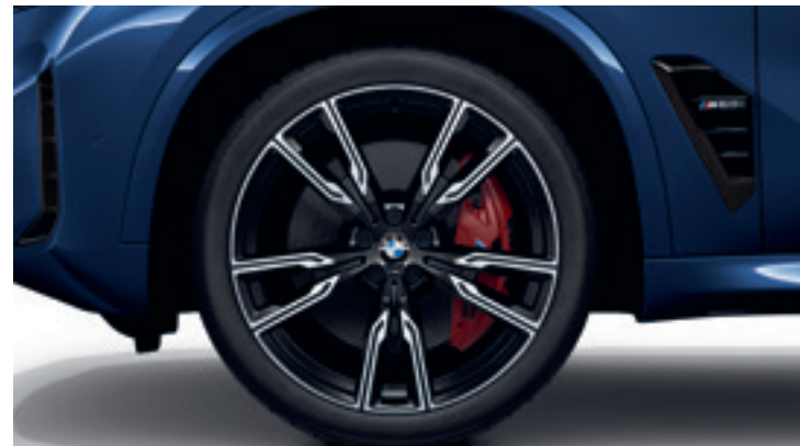
Alliage léger 22" style 742 M Pneus mixtes 9,5 J x 22 / pneus 275/35 R 22 - 10,5 J x 22 / pneus 315/30 R 22
