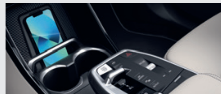
La plaque de recharge sans fil par induction permet de recharger sans câble les mobiles équipés de la technologie de recharge Qi et de les coupler par induction à l'antenne de toit.
