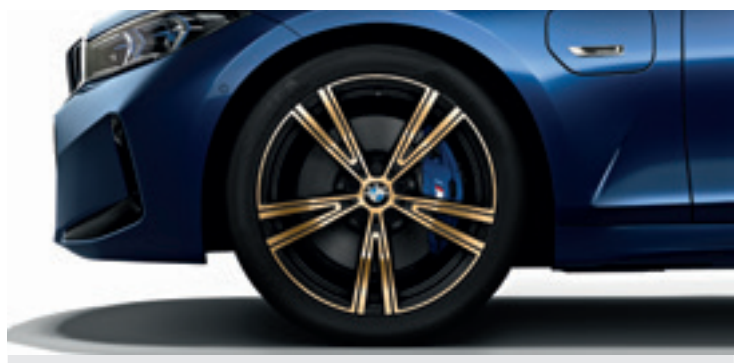
Jantes 19 pouces Night Gold Style 793. Dimensions à l'avant : 8 J x 19 et pneumatiques 225/40 R19 93Y XL Dimensions à l'arrière : 8,5 J x 19 et pneumatiques 255/35 R19 96Y XL
